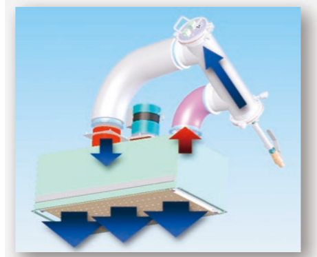
新水冷式“冷凝导管”实现助焊剂回收免保养，冷却效果更胜一筹
